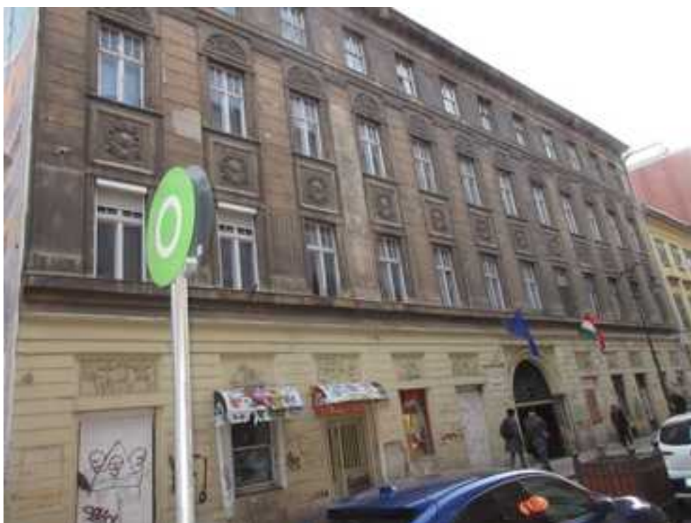
3.,4. Az épület utcai homlokzatának nézete nyugat és észak felől – a 11 tengelyes utcai homlokzat megjelenése, a fő tömegkialakítás és a tetőforma, a rekonstruált klasszicista földszinti homlokzati szakasz és a domborművek, valamint a szecessziós, historizáló emeleti homlokzat és annak tagozatai (övpárkányok, főpárkány, szecessziós vakolati díszek) a földszinti és emeleti nyíláskiosztások és az emeleti szecessziós megjelenésű ablakok nyílászárói műemléki értékű elemek
